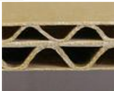
Ötrétegű BC profilú hullámpapír
