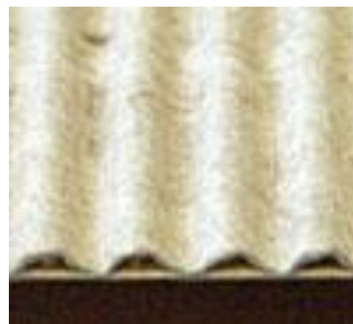
Kétrétegű E profilú hullámpapír
