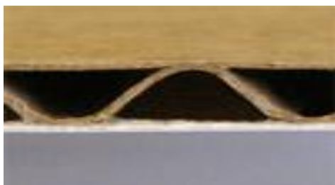
Háromrétegű C profilú hullámpapír
