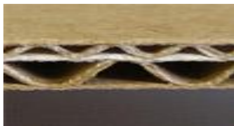
Ötrétegű BE profilú hullámpapír
